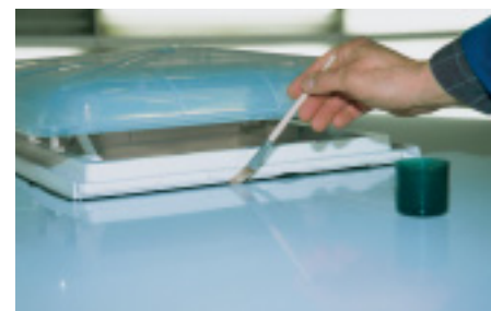
6) Zum Versiegeln der Gummidichtungen benutzen wir einen Pinsel.
