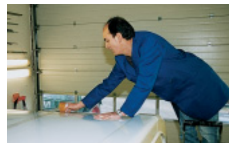
1) Mit einem Klebeband markieren wir eine Trennlinie – nur eine Hälfte wird versiegelt.
