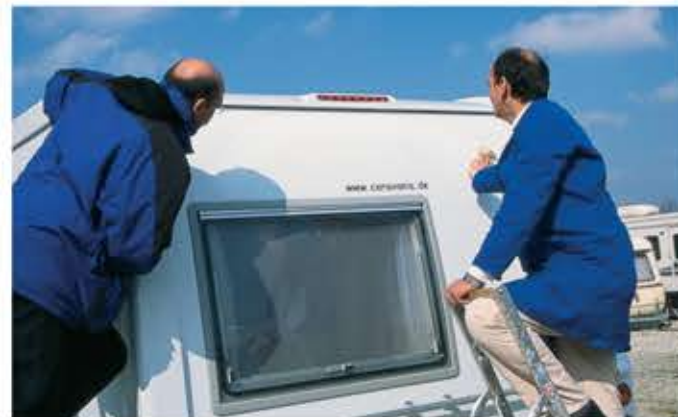
Der Wischtest zeigt, dass die behandelte Hälfte weniger verschmutzt ist und der vorhandene Schmutz sich leichter entfernen lässt.
